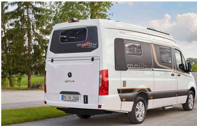
**KOMPAKTE FAHRZEUGLÄNGE DANK INNOVATIVER HECK-EXTENSION MIT BIS ZU 1.400 L STAURAUMVOLUMEN.** Mit unserer innovativen Heck-Extension haben wir den Mercedes-Benz Sprinter von 5,93 auf 6,41 Meter verlängert. Das führt zu einem einzigartigen Fahrzeugkonzept mit einem Maximum an Stauraum von bis zu 1.400 Liter Volumen.
