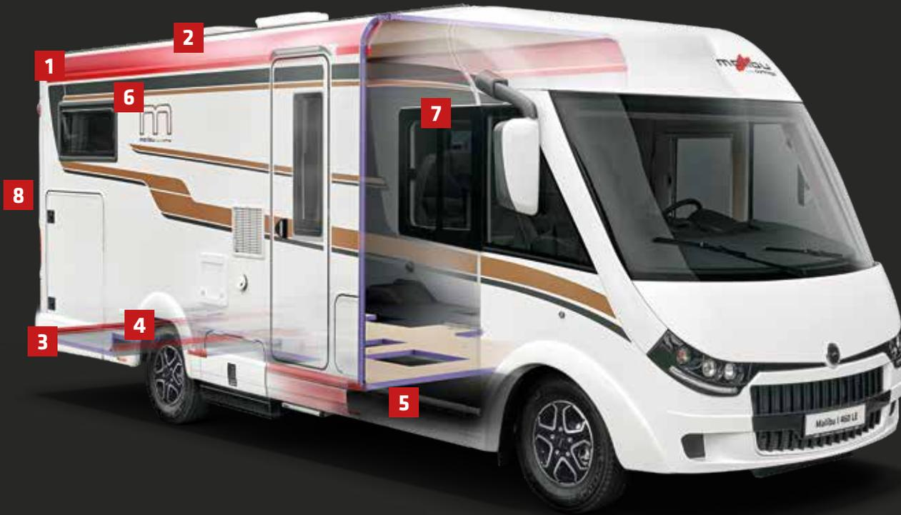
3 Seitenwand- /Bodenverbindung über hochstabilen Tragholm
